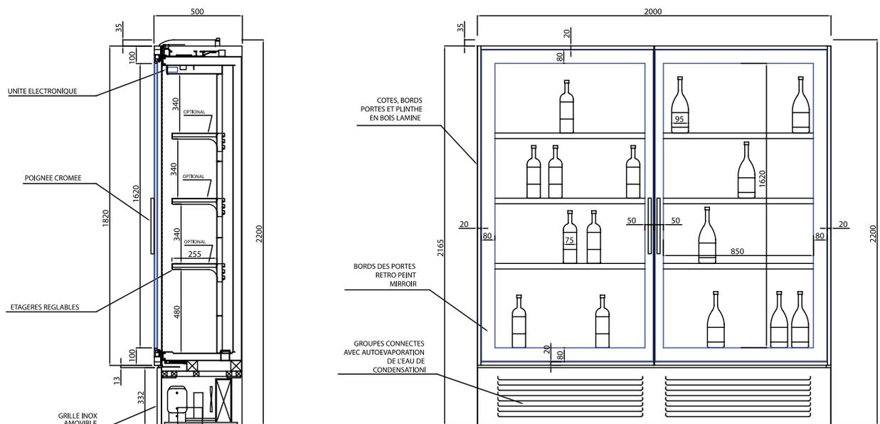
ARMOIRE REALISABLE DANS LA VARIANTE AVEC LES GROU- PUS DISTANTS (SORTIE DES TUYAUX DE L'EVAPORATEUR ET DECHARGEMENT DE L'EAU DANS LE SOL, DETEN- TEUR INTE- GREE) OU AVEC GROU- PES CONNECTES (AVEC GRILLE EN INOX MIRROIR FRONTALE ET BAC POUR L'AUTOEVAPORATION DE L'EAU DE CONDENSATION)
