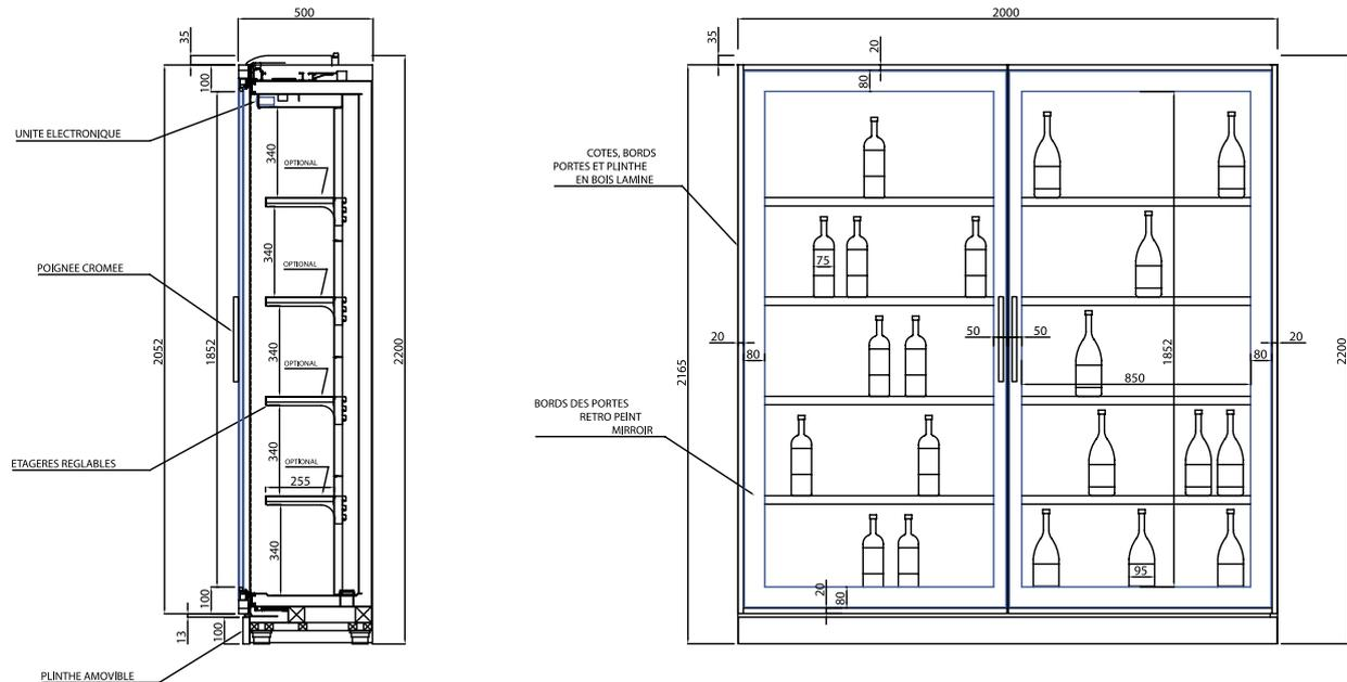
➤ B - AVEC GROUPES CONNECTES, CAPACITE 430+430 LT. (MAX 108+108 BOUTEILLES)
