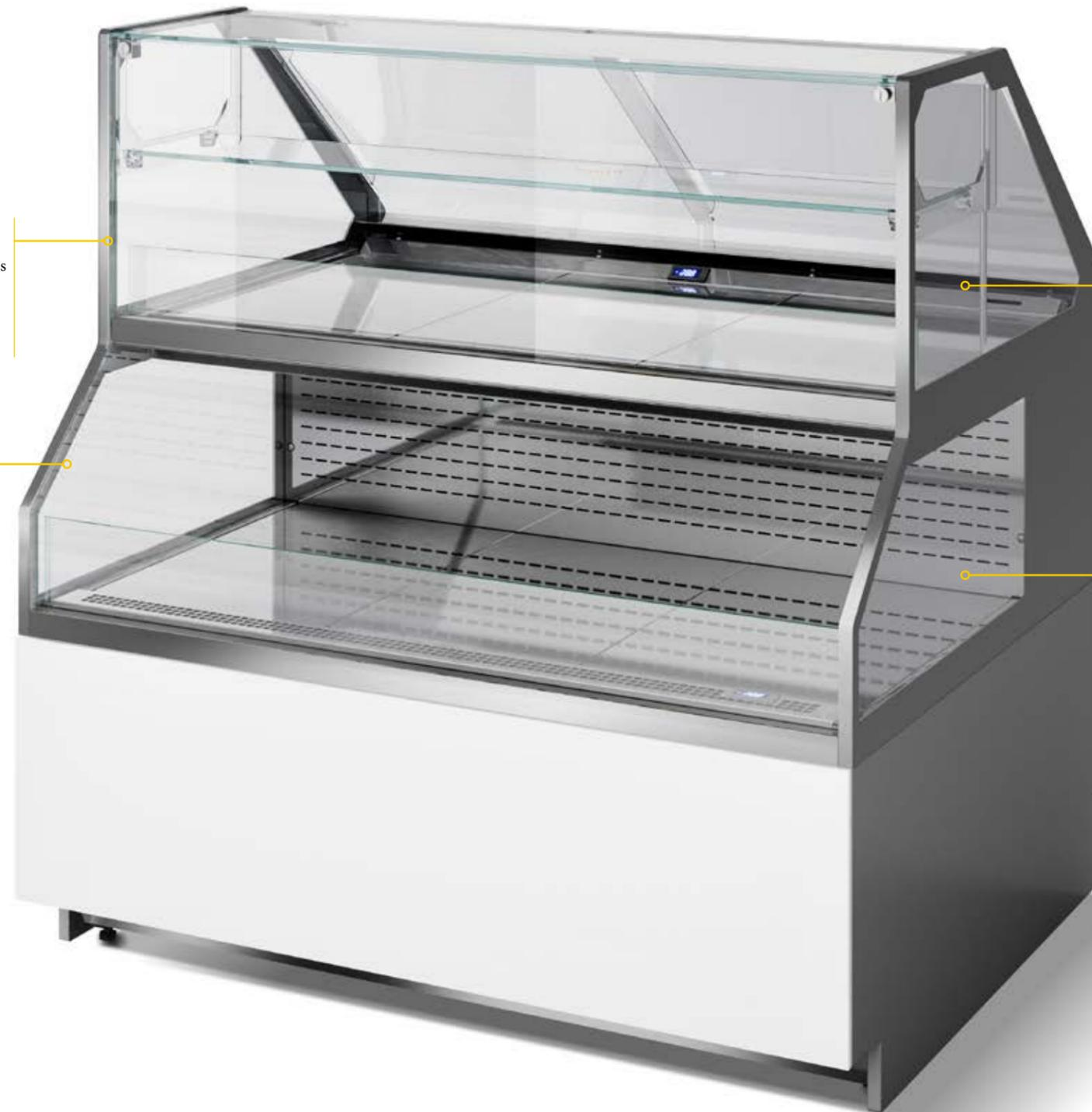
Réfrigération ventilée avec un seul évaporateur pour les deux compartiments. Il est possible de désactiver la réfrigération en rendant uniquement le compartiment supérieur non réfrigéré au moyen d'un bouton sur le panneau de commande. Sur demande, il est possible de chauffer la surface d'affichage (en option) du compartiment supérieur uniquement via un bouton sur le panneau de commande.
