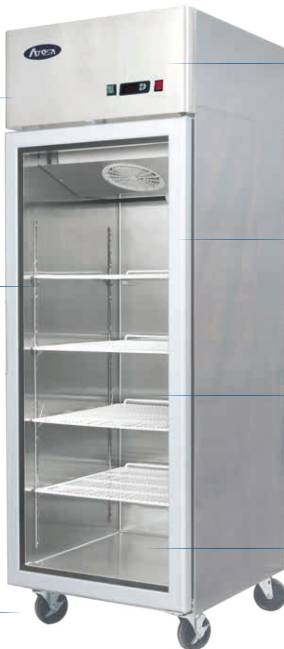
Structure intérieure & extérieure en acier inoxydable AISI 430 (arrière et dessous en acier galvanisé). Isolation enceinte : 60 mm.
